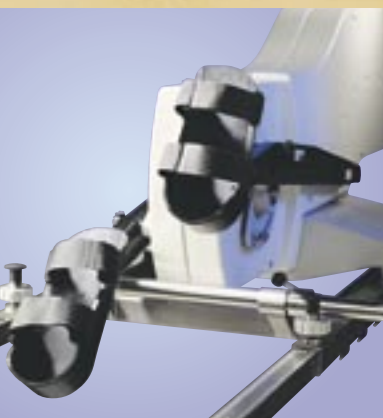
Auf/Ab Bewegung des MRI Ergometers
